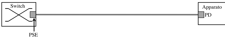
Fig. 6.39 – Schema di collegamento PSE e PD
